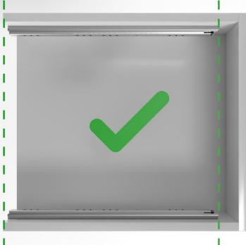
Los carreles exteriores deben estar enrasados y paralelos en la parte delantera.
