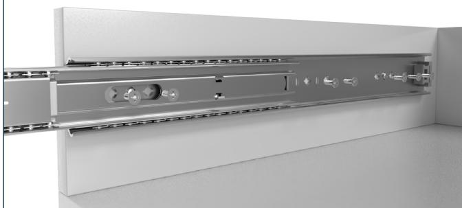
Fijar el carril exterior con tornillos avellanados. Para la carcasa metálica, p. ej., puede emplearse un tornillo de cabeza avellanada M5x16; para la carcasa de madera, un tornillo avellanado 4,5x16 (disponible en nuestra tienda en línea).
