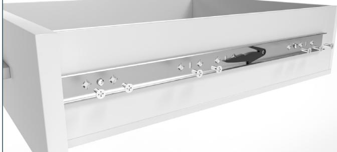
Fijar el carril interior con tornillos de cabeza avellanada. Para la carcasa metálica, p. ej., puede emplearse un tornillo de cabeza avellanada M5x16; para la carcasa de madera, un tornillo avellanado 4,5x16 (disponible en nuestra tienda en línea).
