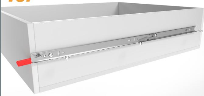
Fijar el carril interior con tornillos. Para carcasa de metal, p. ej., puede emplearse un Tornillo de cabeza plana M4x10; con carcasa de madera, un Tornillo de cabeza plana 4x14 (disponible en nuestra tienda en línea).
