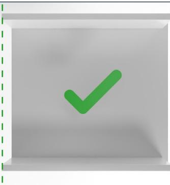
*Las paredes laterales de la carcasa del armario deben estar enrasadas por delante.*
