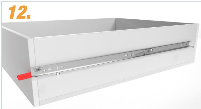
El carril interior puede fijarse en los orificios ranurados con tornillos, p. ej., con tornillo de cabeza redonda de 4 mm (no incluido en el suministro). Los tornillos pueden retirarse opcionalmente después de la instalación.
