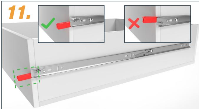
Al montar el carril interior, la palanca de bloqueo debe apuntar hacia abajo.
