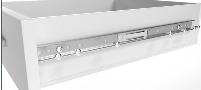
Fijar el carril interior con tornillos de cabeza plana. Para la carcasa metálica, p. ej., puede emplearse un tornillo de cabeza plana M6x16; para la carcasa de madera, un tornillo de cabeza plana 6x16 (disponible en nuestra tienda en línea).
