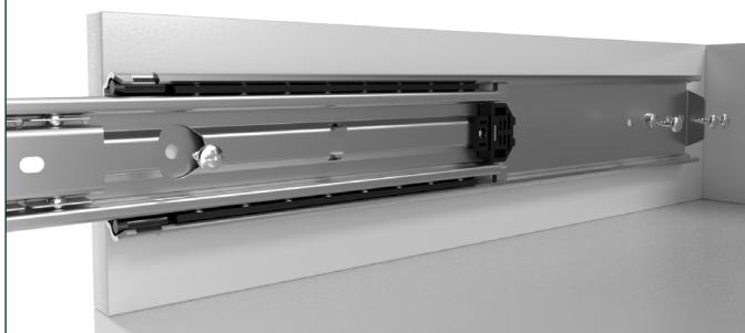
Fijar el carril exterior con tornillos. Para la carcasa metálica, p. ej., emplear un tornillo de cabeza plana M6x16; para la carcasa de madera, un tornillo de cabeza plana 6x16 (disponible en nuestra tienda en línea).
