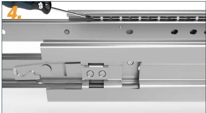
*Si la jaula de bolas se encuentra accidentalmente por encima del tornillo de bloqueo, puede empujarse hacia atrás con un destornillador.*
