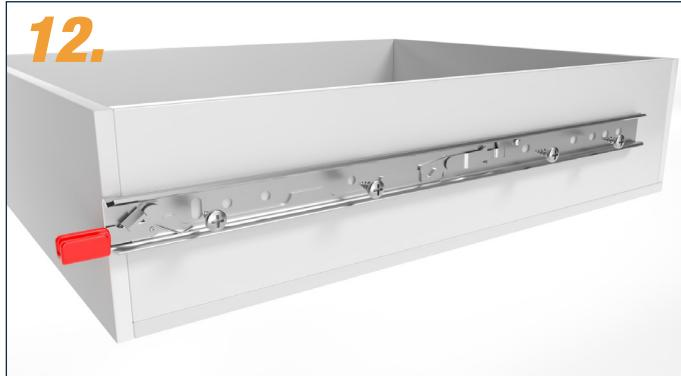
Fijar el carril interior con tornillos de cabeza avellanada. Para la carcasa metálica, p. ej., puede emplearse un tornillo de cabeza plana M6x16; para la carcasa de madera, un tornillo de cabeza plana 6x16 (disponible en nuestra tienda en línea).
