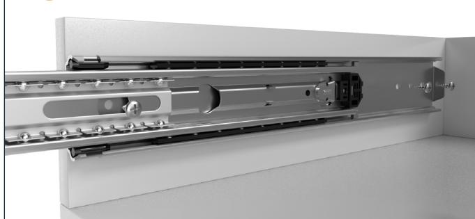
Fijar el carril exterior con tornillos. Para la carcasa metálica, p. ej., emplear un tornillo de cabeza plana M6x16; para la carcasa de madera, un tornillo de cabeza plana 6x16 (disponible en nuestra tienda en línea).
