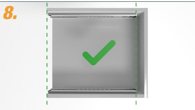
Los carriles exteriores deben estar enrasados y paralelos en la parte delantera.
