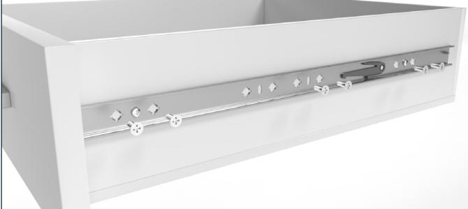
Fijar el carriel interior con tornillos de cabeza avellanada. Para la carcasa metálica, p. ej., puede emplearse un tornillo de cabeza avellanada M5x16; para la carcasa de madera, un tornillo avellanado 4,5x16 (disponible en nuestra tienda en línea).
