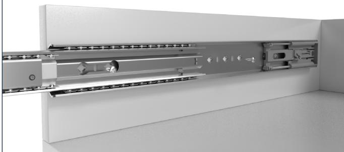
El carriel exterior puede fijarse y alinearse en los orificios ranurados con tornillos, p. ej., con tornillo de cabeza redonda de 4 mm (no incluido en el suministro). Los tornillos pueden retirarse opcionalmente después de la instalación.
