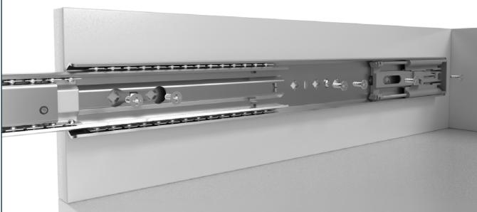
Fijar el carriel exterior con tornillos avellanados. Para la carcasa metálica, p. ej., puede emplearse un tornillo de cabeza avellanada M5x16; para la carcasa de madera, un tornillo avellanado 4,5x16 (disponible en nuestra tienda en línea).
