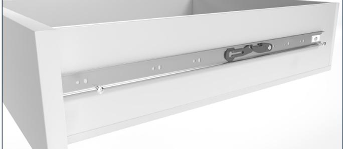
El carril interior puede fijarse en los orificios ranurados con tornillos, p. ej., con tornillo de cabeza redonda de 4 mm (no incluido en el suministro).
