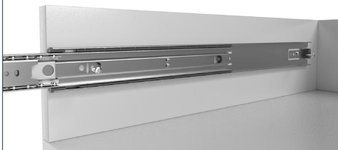
Fijar el carril exterior con tornillos. Para carcasa de metal, p. ej., puede emplearse un Tornillo de cabeza plana M4x8; con carcasa de madera, un Tornillo de cabeza plana 4x14 (disponible en nuestra tienda en línea).
