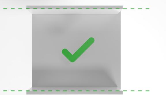
*Las paredes laterales de la carcasa del armario deben estar paralelas.*
