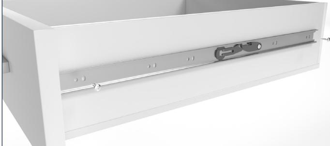
El carril interior puede fijarse en los orificios ranurados con tornillos, p. ej., con tornillo de cabeza redonda de 4 mm (no incluido en el suministro). Los tornillos pueden retirarse opcionalmente después de la instalación.
