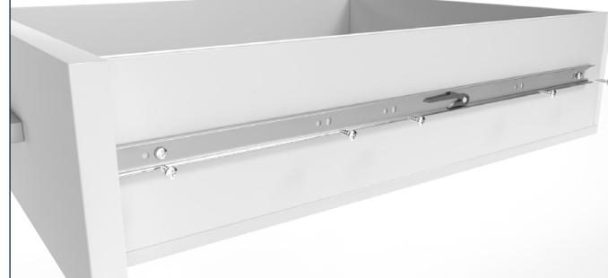
Fijar el carril interior con tornillos. Para carcasa de metal, p. ej., puede emplearse un Tornillo de cabeza plana M4x10; con carcasa de madera, un Tornillo de cabeza plana 4x14 (disponible en nuestra tienda en línea).
