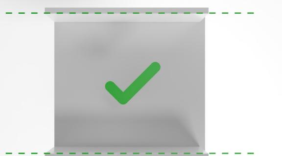
*Las paredes laterales de la carcasa del armario deben estar paralelas.*
