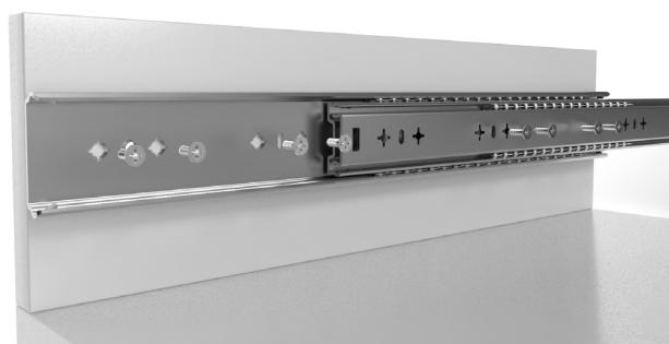
Fijar el carril exterior con tornillos avellanados. Para la carcasa metálica, p. ej., puede emplearse un tornillo de cabeza avellanada M5x16; para la carcasa de madera, un tornillo avellanado 4,5x16 (disponible en nuestra tienda en línea).
