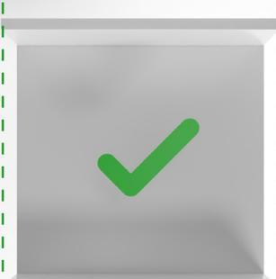
Las paredes laterales de la carcasa del armario deben estar enrasadas por delante.
