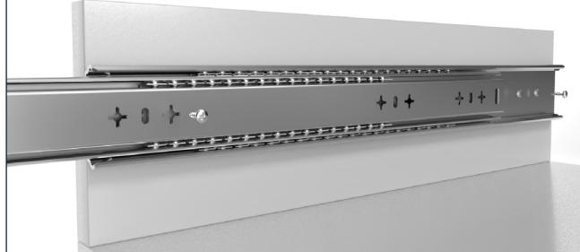
El carril exterior puede fijarse y alinearse en los orificios ranurados con tornillos, p. ej., con tornillo de cabeza redonda de 4 mm (no incluido en el suministro). Los tornillos pueden retirarse opcionalmente después de la instalación.
