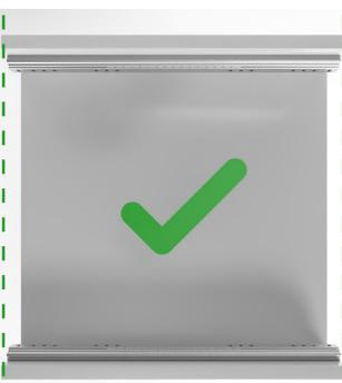
Los carriles exteriores deben estar enrasados y paralelos en la parte delantera.
