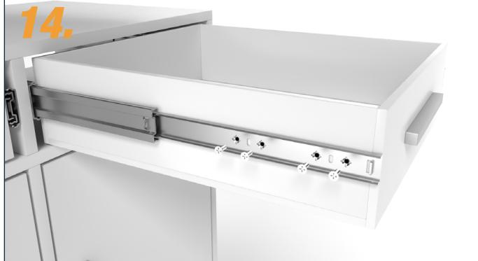
Fijar el carril interior con tornillos de cabeza avellanada. Para la carcasa metálica, p. ej., puede emplearse un tornillo de cabeza avellanada M5x16; para la carcasa de madera, un tornillo avellanado 4,5x16 (disponible en nuestra tienda en línea).
