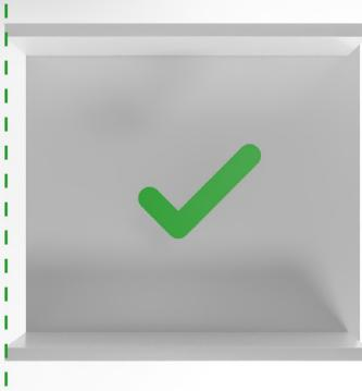
Les parois latérales du corps de l'armoire doivent être alignées à l'avant.
