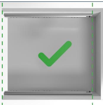
Les rails extérieurs doivent être parallèles et affleurer à l'avant.
