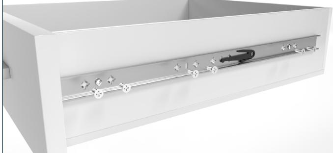
Fixer le rail intérieur avec des vis à tête fraisée. Pour un corps en métal, par ex. avec une vis à tête fraisée M5x16, pour un corps en bois, p. ex. Avec une vis à tête fraisée 4,5x16 (disponible dans notre boutique en ligne).
