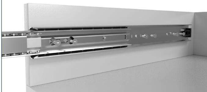
Fixer le rail extérieur avec des vis à tête fraisée. Pour un corps en métal, par ex. avec une vis à tête fraisée M5x16, pour un corps en bois, par ex. Avec une vis à tête fraisée 4,5x16 (disponible dans notre boutique en ligne).
