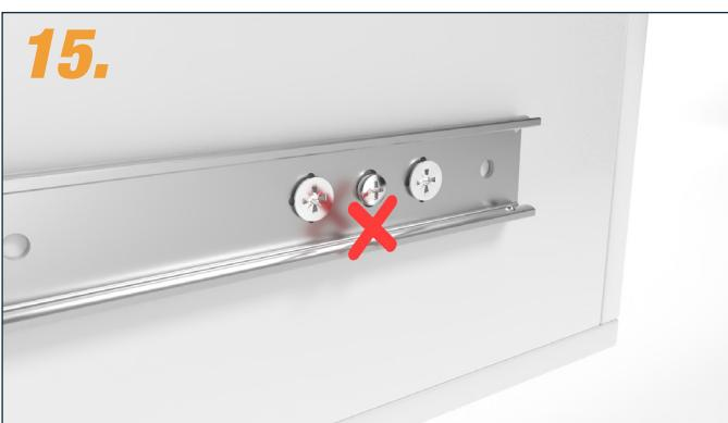
Aucune tête de vis ne doit dépasser dans les trous arrière.
