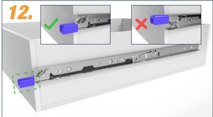
Lors du montage du rail intérieur, le levier de verrouillage doit être orienté vers le haut.
