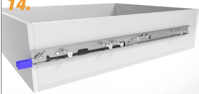
Fixer le rail intérieur avec des vis à tête fraisée. Pour un corps en métal, par ex. avec une vis à tête fraisée M5x16, pour un corps en bois, p. ex. Avec une vis à tête fraisée 4,5x16 (disponible dans notre boutique en ligne).
