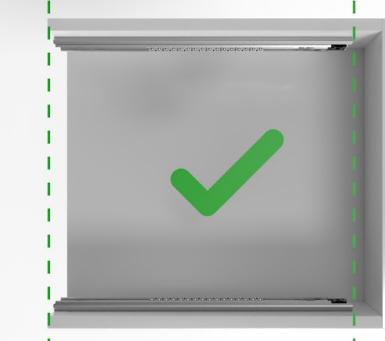
Les rails extérieurs doivent être parallèles et affleurer à l'avant.
