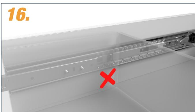
Une mauvaise manipulation peut entraîner le blocage du rail. Nous déclinons toute responsabilité en cas de dommages causés à la cage à billes par une réinsertion incorrecte.
