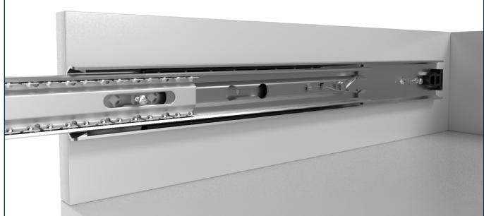
Le rail extérieur peut être fixé dans les trous oblongs à l'aide de vis et encore aligné, par ex. avec une vis à tête ronde de 4 mm (non fournie). Les vis peuvent être retirées en option après le montage.
