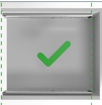
Les rails extérieurs doivent être parallèles et affleurer à l'avant.
