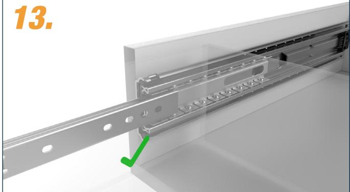
Avant le montage, la cage à billes doit être poussée vers l'avant.
