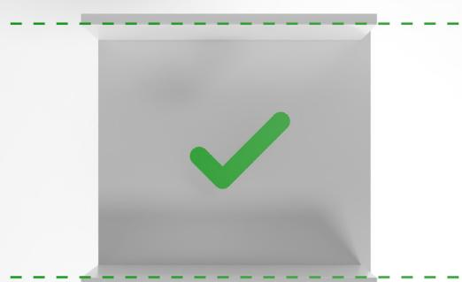
Les parois latérales du corps de l'armoire doivent être parallèles.
