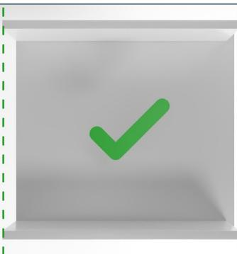
Les parois latérales du corps de l'armoire doivent être alignées à l'avant.
