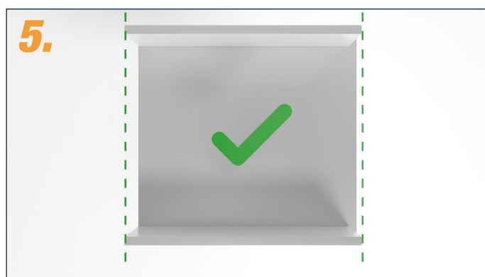
5. Les parois latérales du corps de l'armoire doivent être alignées à l'avant.
