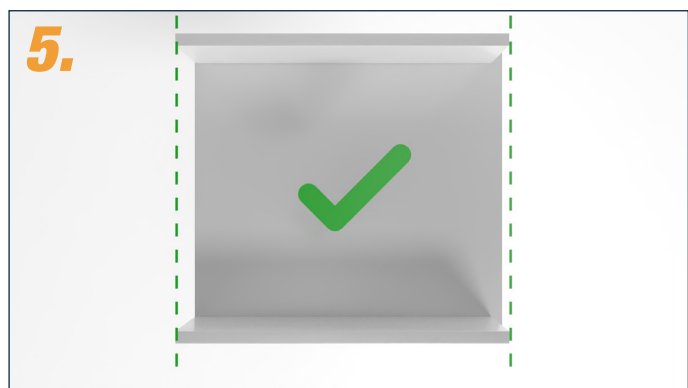
Les parois latérales du corps de l'armoire doivent être alignées à l'avant.
