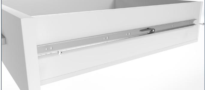
Le rail intérieur peut être fixé avec des vis dans les trous oblongs.
