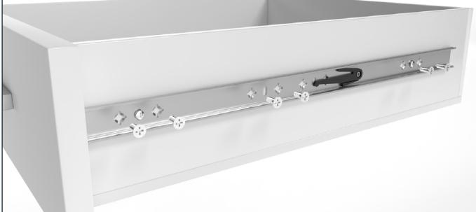
Fissare la guida interna con viti a testa svasata. Per un corpo in metallo, utilizzare ad es. una vite a testa svasata M5x16, per un corpo in legno, utilizzare ad es. Una vite a testa svasata 4,5x16 (disponibile nel nostro negozio online).
