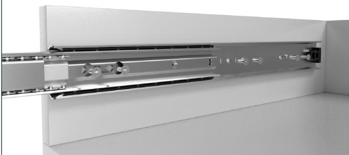
Fissare la guida esterna con viti a testa svasata. Per un corpo in metallo, utilizzare ad es. viti a testa svasata M5x16, per un corpo in legno, utilizzare ad es. una vite a testa svasata 4,5x16 (disponibile nel nostro negozio online).
