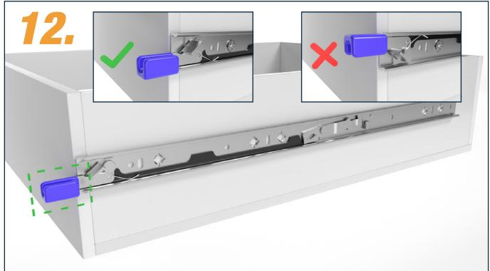
Quando si installa la guida interna, la leva di bloccaggio deve essere rivolta verso l'alto.
