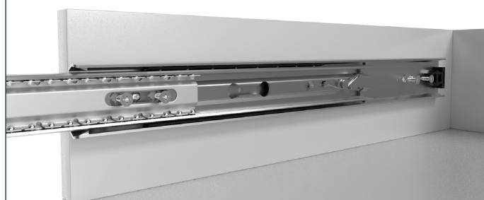
Fissare la guida esterna con viti a testa svasata. Per un corpo in metallo, utilizzare ad es. viti a testa svasata M5x16, per un corpo in legno, utilizzare ad es. una vite a testa svasata 4,5x16 (disponibile nel nostro negozio online).
