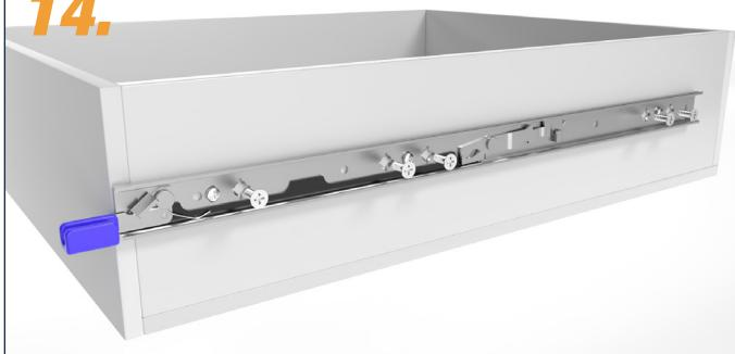
Fissare la guida interna con viti a testa svasata. Per un corpo in metallo, utilizzare ad es. una vite a testa svasata M5x16, per un corpo in legno, utilizzare ad es. Una vite a testa svasata 4,5x16 (disponibile nel nostro negozio online).
