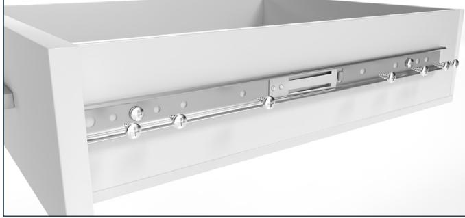
Fissare la guida interna con viti a testa piatta. Per un corpo in metallo, utilizzare ad es. una vite a testa piatta M6x16, per un corpo in legno, utilizzare ad es. Una vite a testa piatta 6x16 (disponibile nel nostro negozio online).
