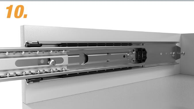
Fissare la guida esterna con viti. Per un corpo in metallo, utilizzare ad es. con vite a testa piatta M6x16, per un corpo in legno, utilizzare ad es. una vite a testa piatta 6x16 (disponibile nel nostro negozio online).
