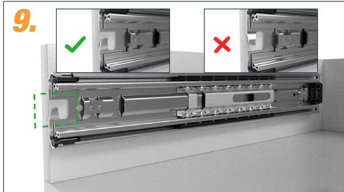
Si raccomanda di fare in modo che la linguetta della guida esterna sia rivolta verso l'alto.
