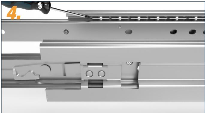
Se la gabbia a sfere si trova accidentalmente sopra la vite di bloccaggio, è possibile spingerla all'indietro con un cacciavite.
