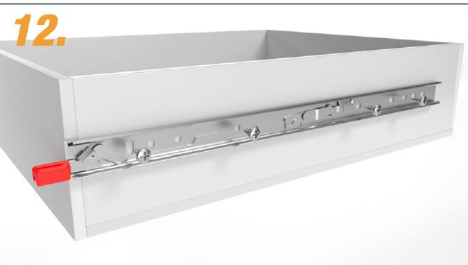
Fissare la guida interna con viti a testa svasata. Per un corpo in metallo, utilizzare ad es. una vite a testa piatta M6x16, per un corpo in legno, utilizzare ad es. Una vite a testa piatta 6x16 (disponibile nel nostro negozio online).
