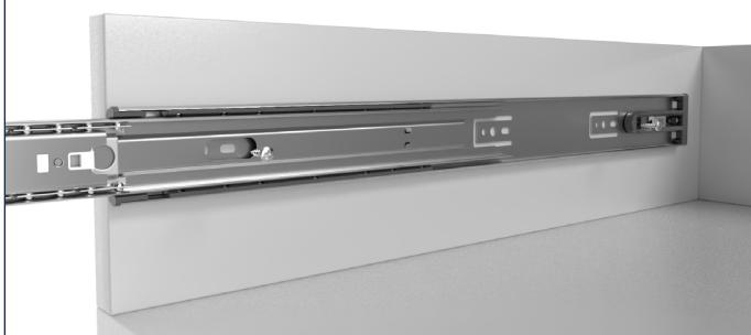
La guida esterna può essere fissata con delle viti nei fori asolati e può inoltre essere allineata, ad es. con vite a testa tonda da 4 mm (non inclusa nella fornitura). A scelta, è possibile rimuovere nuovamente le viti dopo il montaggio.
