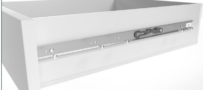
Fissare la guida interna con le viti. Per un corpo in metallo, si può usare ad es. una Vite a testa piatta M4x10, per un corpo in legno, si può usare ad es. una Vite a testa piatta 4x14 (disponibile nel nostro negozio online).
