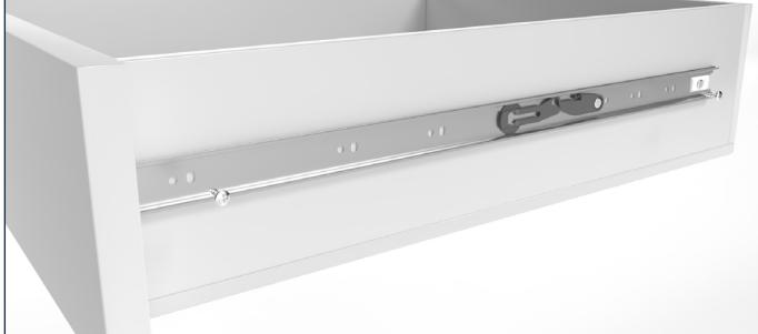
La guida interna può essere fissata con viti nei fori asolati ad es. con viti a testa tonda da 4 mm (non incluse nella fornitura). A scelta, è possibile rimuovere nuovamente le viti dopo il montaggio.
