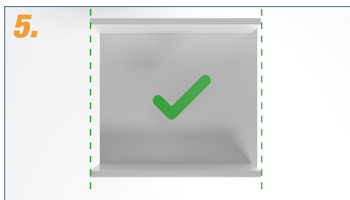
5. Le pareti laterali del corpo dell'armadio devono essere a filo con la parte anteriore.
